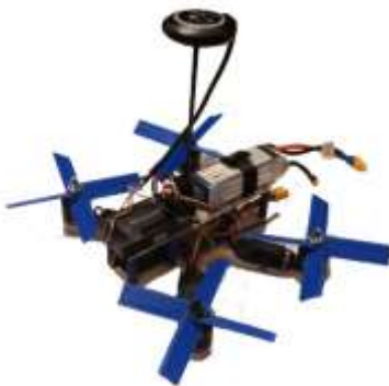
Рисунок 1 - Мультироторный летательный аппарат (квадрокоптер), полностью собранный из деталей, напечатанных на 3d принтере
